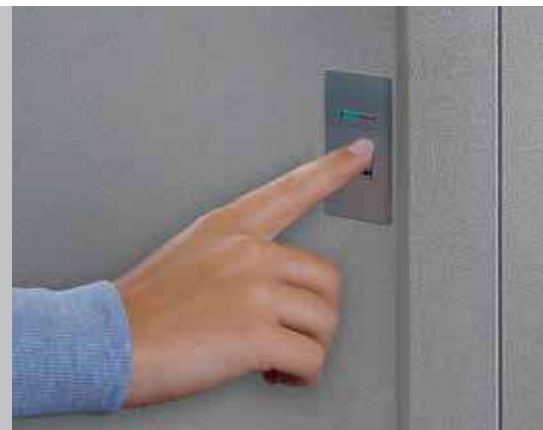
Öffnung über einen im Türblatt eingebauten Fingerleser
